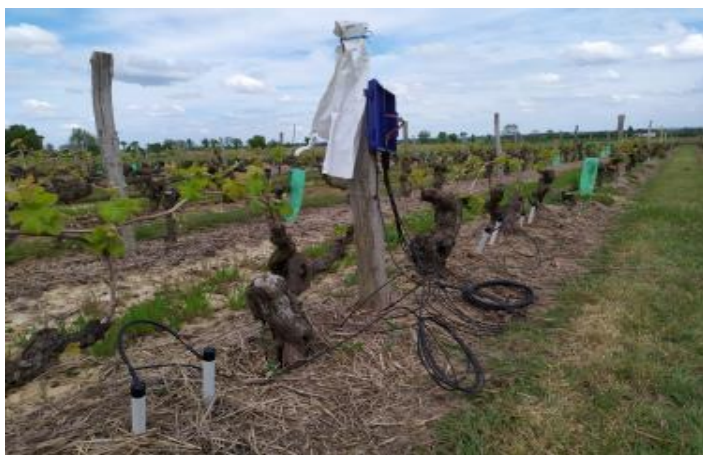
Sondes disposées dans le sol pour la modalité « paille de blé »
