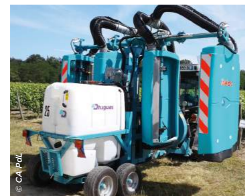
Tunnel de traitement
