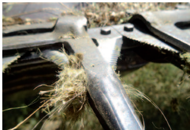
Bourrage sur la lame de coupe
