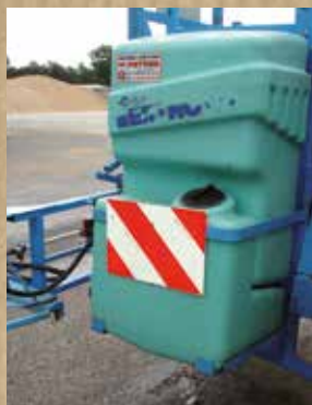
Cuve de rinçage
