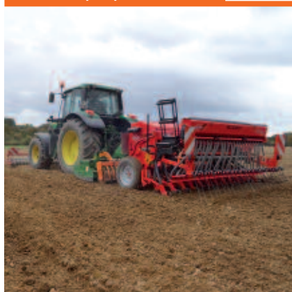
Semis simultanée trèfle blanc nain + blé tendre d'hiver avec un semoir double caisson
