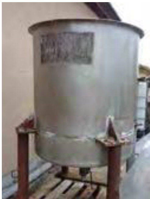
Stérilisateur de 300 L utilisé en exploitation viticole
