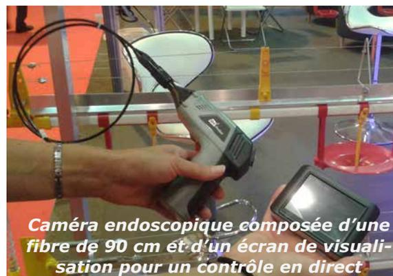
Caméra endoscopique composée d'une fibre de 90 cm et d'un écran de visualisation pour un contrôle en direct
