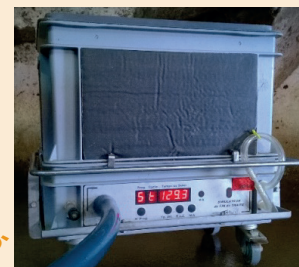
Simulateur de fin de traite, utilisé pendant le Dépos'Traite®
