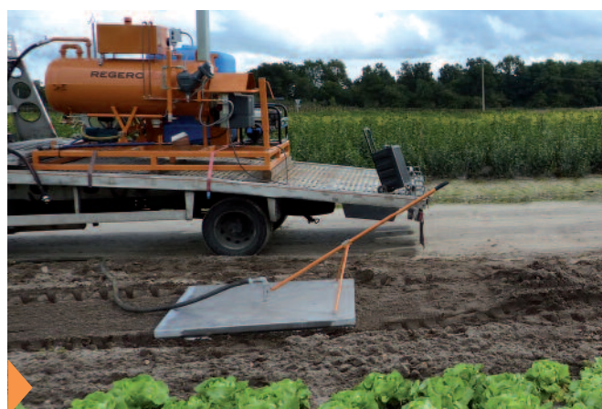
Exemple de désinfection vapeur avec une machine Regero.
