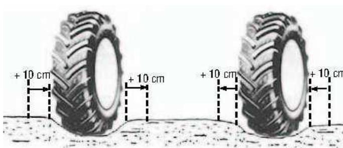
Pour les ornières profondes de plus de 10 cm, on retient la largeur totale du véhicule (entre les deux ornières) majorée de 50 cm de part et d'autre avec un minimum de 4 m.
