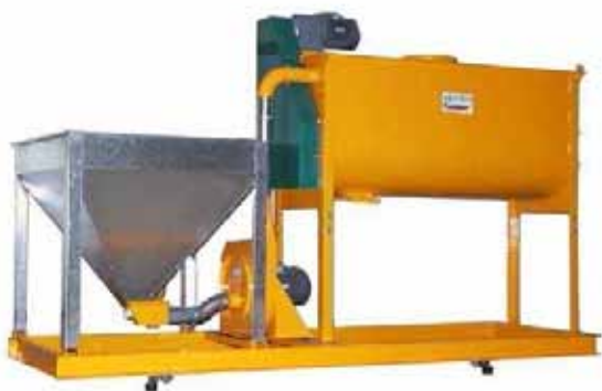
Exemple de châssis de pesage avec broyeur et mélangeuse horizontale
